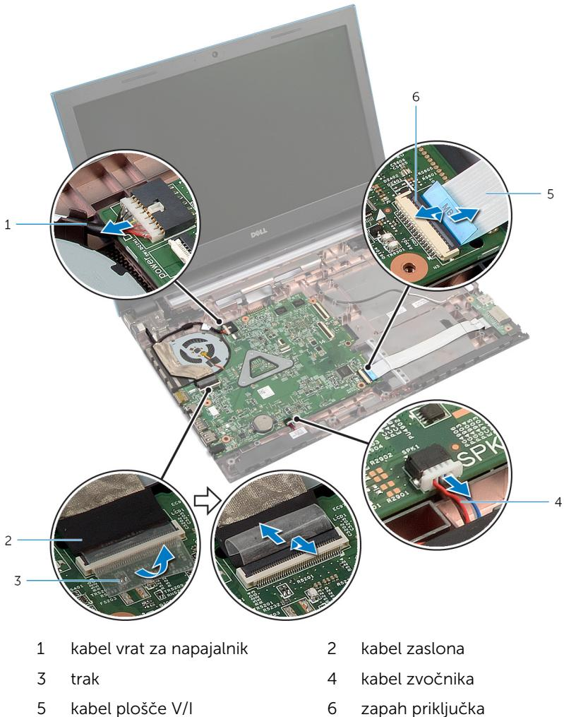
1 kabel vrat za napajalnik
